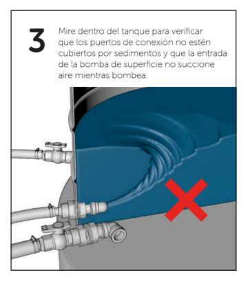
**CONSEJO**: Si se ve un remolino dentro del tanque, entonces el nivel de agua es demasiado bajo para el caudal que se bombea. Deje que el tanque se llene a un nivel más alto. Si esto ocurre con regularidad, deberá girar el codo en el interior de la tanque para que apunte más hacia abajo.
