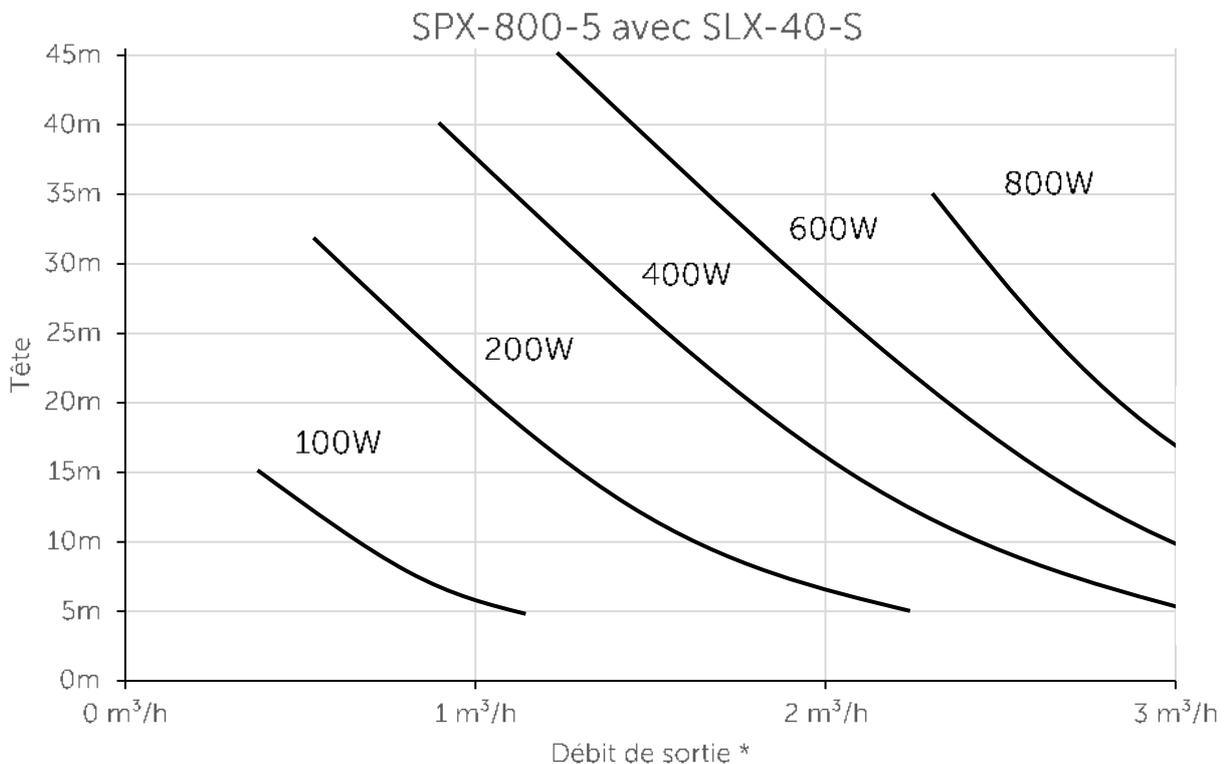
\* Le graphique reflète les données réelles de la pompe à une température de l'eau de 25 °C, y compris les pertes dues aux tuyaux en PEHD PN16 de 40 mm. Les données de performance publiées par les fabricants de pompes submersibles électriques doivent être corrigées pour tenir compte des frottements dans les tuyaux et des pertes de câbles (non incluses normalement) à des fins de comparaison. Ces pertes réduisent souvent l'efficacité d'au moins 5 %.
